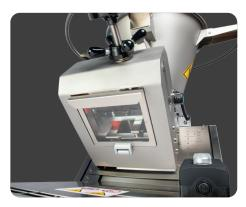
Über ein Sichtfenster ist das Kolbensystem zu sehen und einfach zu reinigen.
