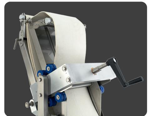
Der Abwieger 6300 kann über sein Hochtransport zur Beschickung von Brotaufarbeitungsanlagen mit hohem Einlauf eingesetzt werden. Durch eine Kurbel wird der Transportspalt angepasst.
