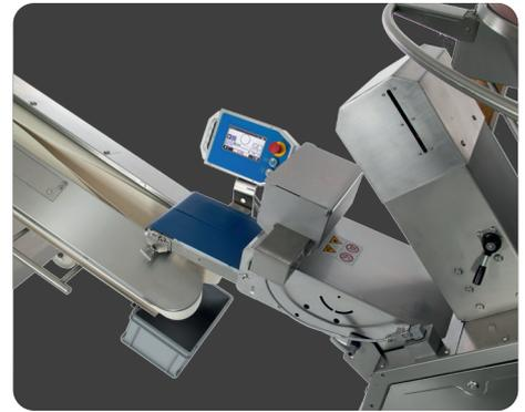
Beim Abwieger 7500 sorgt ein drehbares XL Display für eine einfache Bedienung. Über das Memory-Pack lassen sich bis zu 250 Rezepte speichern. Die motorisierte Abwiegekammer übernimmt dabei auch die Gewichte aus dem Rezeptspeicher.
